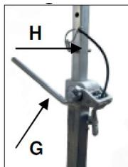
Coloque el soporte de perforación. Sitúe el dispositivo de fijación lo más cerca posible por detrás de la columna en la base del soporte. Fije el soporte girando el eje (G) en el sentido de las agujas del reloj. Fije la instalación con el perno apropiado (H).
