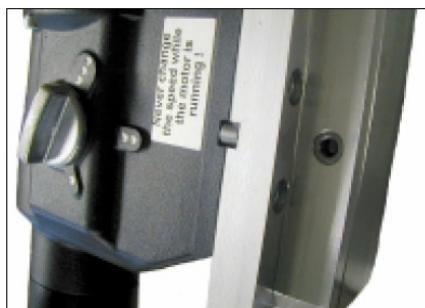
Le support de carotteuse P-54190 est livré avec une plaque de maintien, une clé plate de 10mm et 4 vis M8. La plaque de maintien se fixe sur l'outil à l'aide la clé de telle manière à ce que l'accouplement soit du même coté que du sélecteur de vitesse.Puis visser les 4 vis.
