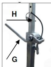
Anbring borestationen. Anbring fastspændingsanordningen så tæt så muligt bag stangen på borestationen. Fastgør stationen ved at skru kranken (G) med uret. Stationen sikres med dertil hørende bolte (H).
