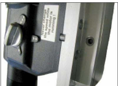
Zum Lieferumfang des Bohrständers DBM230 gehört eine Montageplatte, eine Passfeder 10 mm und 4 Innensechskantschrauben M8. Die Montageplatte wird mit der Passfeder so auf die Maschine aufgesetzt, dass sich die Buchse in der Montageplatte auf der gleichen Seite befindet wie die Getriebeumschaltung der Maschine. Danach werden die vier Schrauben eingesetzt und fest angezogen.
