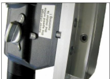
O suporte de perfuração P-54190 consta de uma placa de montagem, uma chave de fixação de 10 mm e 4 parafusos fêmea hexagonais M8. A placa de montagem é fixa à ferramenta com a chave de fixação, de modo a permitir que o acoplamento na placa de montagem seja feito do mesmo lado em que se muda as velocidades do motor. Depois, introduzem-se e apertam-se os quatro parafusos.
