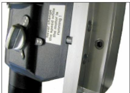
El soporte de perforaci n P-54190 incluye una placa de montaje, una llave de ajuste de 10 mm y 4 tornillos Allen de M8 de cabeza hueca hexagonal. La placa de montaje se fija en la herramienta con la llave de ajuste de forma que el acoplamiento en la placa de montaje quede en el mismo lado que el cambio de marchas del motor. Luego se colocan y se aprietan los 4 pernos.
