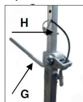
Positionieren Sie den Bohrständler. Setzen Sie die Schnellspannsäule so dicht wie möglich hinter der Säule auf dem Ständerfuß auf. Fixieren Sie den Bohrständler durch Drehen der Kurbel (G) in Uhrzeigersinn. Sichern Sie die Einstellung mit dem dazugehörigen Bolzen (H).
