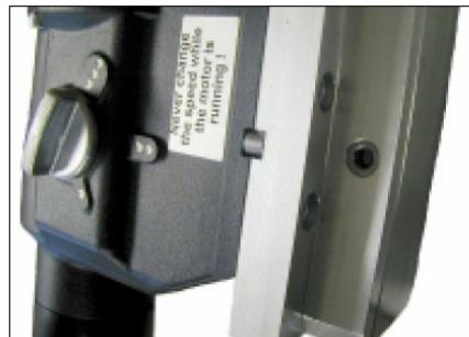
De boorstandaard P-54190 wordt geleverd met een montageplaat, een 10 mm passpie en 4 inbusbouten M8. De montageplaat wordt zodanig op de machine geplaatst met de passpie dat verbinding op de montage plaat aan dezelfde zijde zit als de toerenregeling van de motor. Daarna worden de 4 inbusbouten geplaatst en vast gezet.
