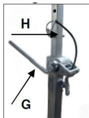
Coloque a placa de perfuração na posição adequada. Coloque o dispositivo de fixação o mais perto possível atrás da coluna na base da placa de montagem. Fixe a placa, rodando a manivela (G) no sentido dos ponteiros do relógio. Fixe a instalação usando a cavilha adequada (H).
