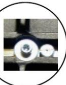
Apriete el mango de vacío con una arandela y un perno de cabeza hueca hexagonal de M8x30.
