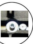
Sichern Sie den Vakuumgriff mit Hilfe der Unterlegscheibe und Innensechskantschraube M8x30.
